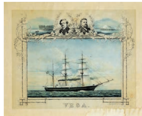
SS Vega oli kolmimastoinen puurakenteinen purjelaiva, jossa oli 70 hevosvoiman kone. Aluksen pituus oli 46 metriä, ja sen kapasiteetti oli 357 tonnia. Se rakennettiin vuonna 1872 valaanpyyntialukseksi. Se muunnettiin Ruotsissa sopivaksi Nordenskiöldin tarpeita vastaavaksi. Kuva: John Nurmisen Säätiön kokoelmat
