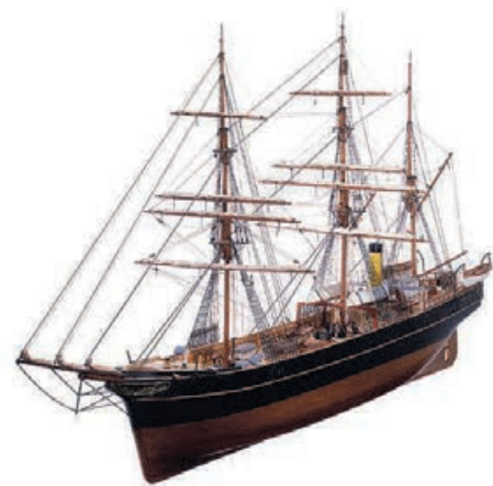
SS Vega var ett segelfartyg i trä med tre master och en 70 hästkrafters ångmaskin som hjälpmotor. Fartyget var 46 meter långt och kunde lasta 357 ton. Det var byggt 1872 som valfångstfartyg. Det modifierades i Sverige för att passa Nordenskiölds behov. Bild: John Nurminens Stiftelse
