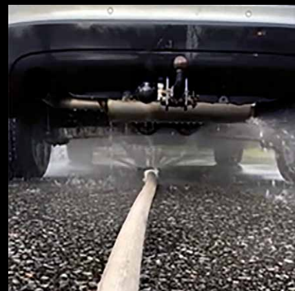
En skafftörsedd släckare är ett annat effektivt sätt: man för in den under batteriet och öppnar kranen. Det är enkelt och säkert.
