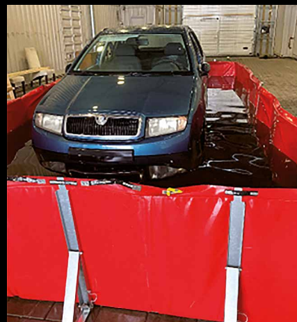
Yksi tapa sammuttaa akkupalo on upottaa auto vesialtaaseen. Menetelmä on hankala lyhyillä merimatkoilla, koska upotusaika on pitkä, ja auto pitää saada nopeasti ulos autokannelta.
