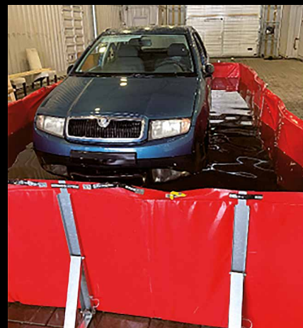
Ett sätt är att sänka ner bilen i en vattenbassäng, som innehåller så mycket vatten att batteriet täcks. Metoden är krånglig på korta sjöresor.
