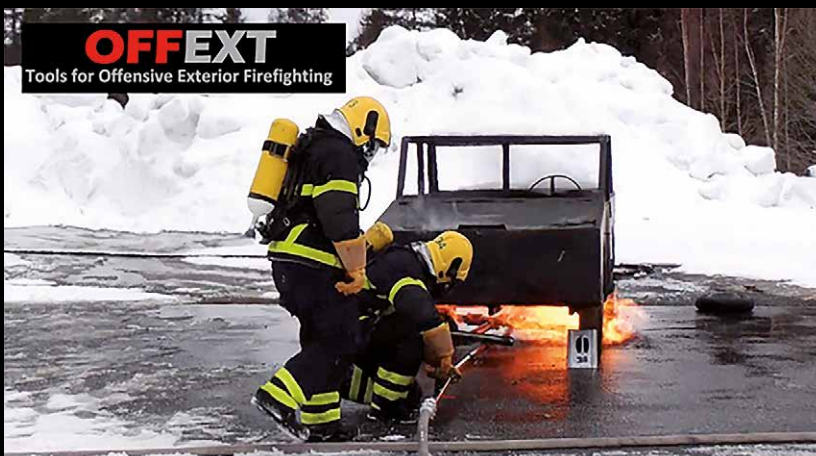
Litiumioniakun palon sammuttaminen on hankalaa, koska syttymisreaktio ei vaadi ulkopuolista happea. Sähköautoissa ongelma vielä korostuu, koska akku on suuri, hankalassa paikassa ja hyvin suojattu.
