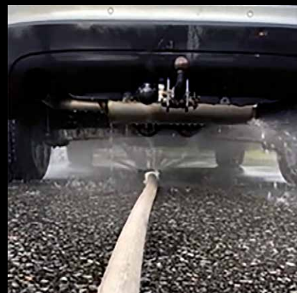
Varsisammutin on myös tehokas keino: laite viedään akun alle ja aukaistaan hana. Se on helppoa ja turvallista.
